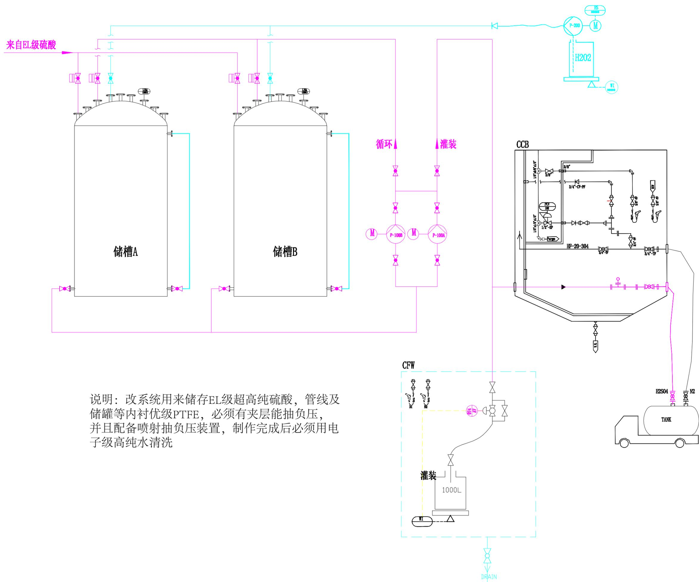
说明：改系统用来储存EL级超高纯硫酸，管线及储罐等内衬优级PTFE，必须有夹层能抽负压，并且配备喷射抽负压装置，制作完成后必须用电子级高纯水清洗
